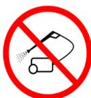
L'usage d'un nettoyeur haute pression est absolument interdit au risque d'annuler la garantie.
